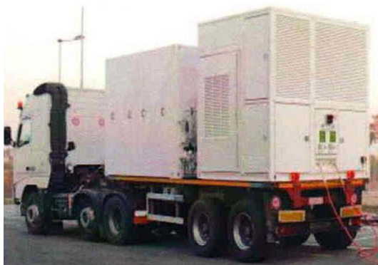
Рис. 42- Автомобильная газонаполнительная компрессорная станция.
